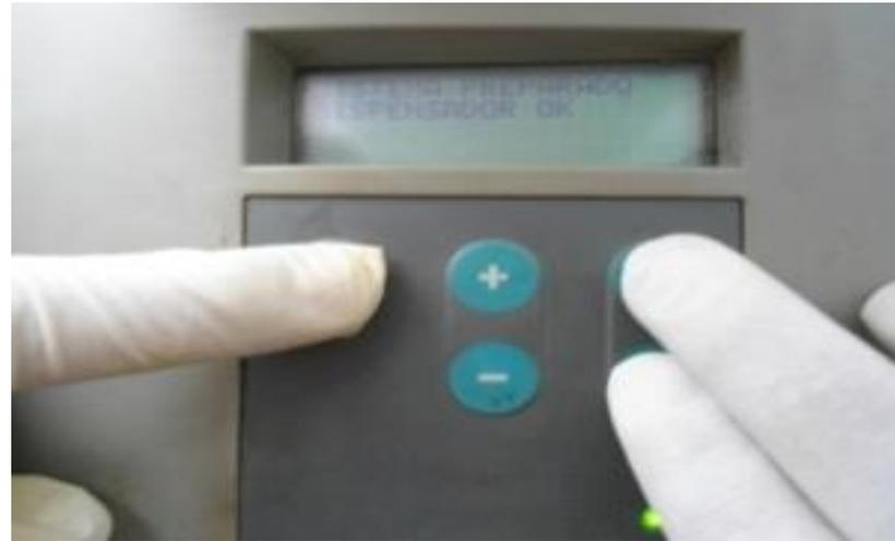
Las pantallas contenidas en el modo diagnóstico sirven para verificar el funcionamiento de algunos parámetros del sistema de inyección.
